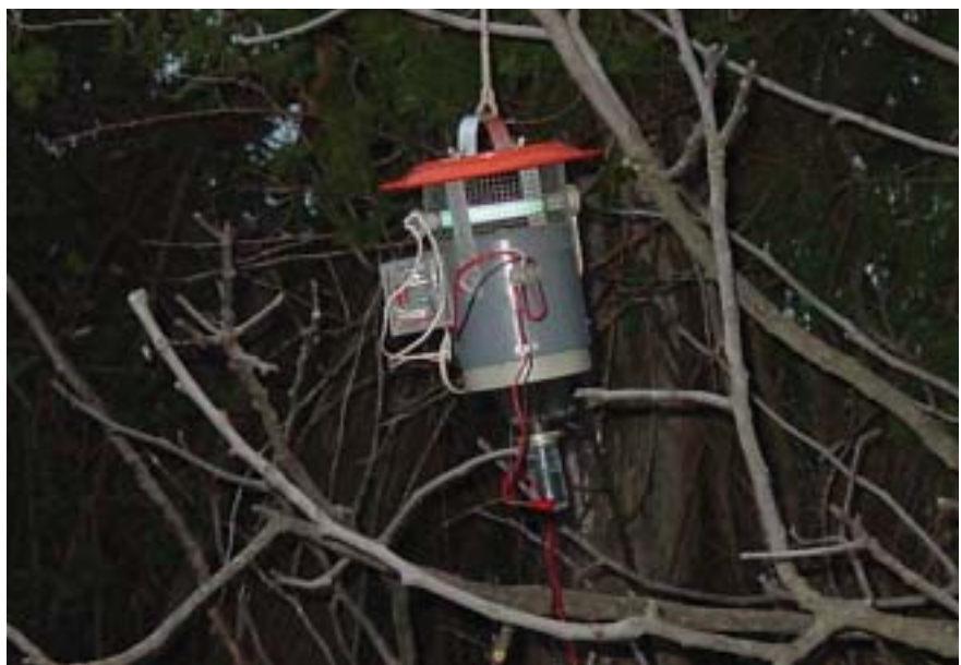
Piège lumineux UV standard utilisé pour capturer les Culicoides - Cliché T. Baldet / CIRAD-EMVT
